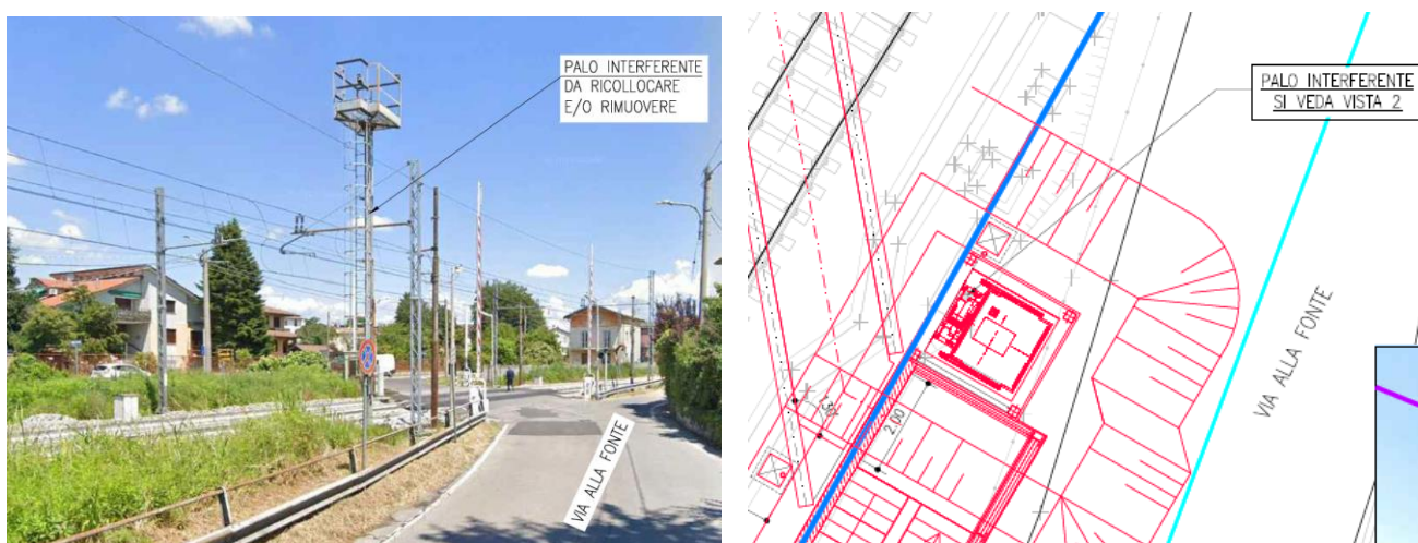
Figura 8 – Palo TVCC interferente con vano scala
